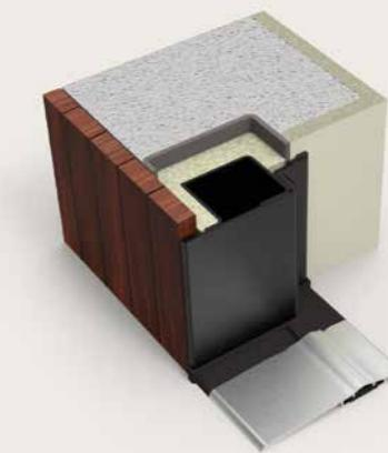
21. Controtelaio e telaio porta a bilico Di.Big per rivestimento muro interno
