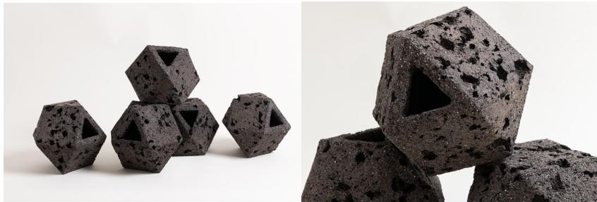
Il progetto di Guan è una suggestiva installazione a pavimento, illuminata da lampadine, e realizzata con il POLiROCK, un nuovo materiale sviluppato dal Material Architecture Lab, che consiste in argilla cotta con caratteristiche uniche, a metà strada tra la ceramica e le rocce. Sembra naturale, eppure è fatta riciclando gli scarti di produzione.
